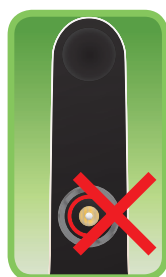
Alineación incorrecta del tonómetro e indicación luminosa roja de la base para sonda.
