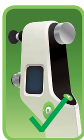
Alineación correcta del tonómetro e indicación luminosa verde de la base para sonda.
