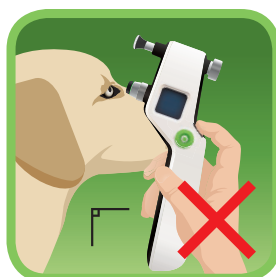
Alignement incorrect du tonomètre et témoin lumineux rouge sur le support de la sonde.
