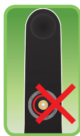
Allineamento errato del tonometro e spia sulla base della sonda di colore rosso.
