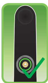
Corretto allineamento del tonometro e spia sulla base della sonda di colore verde.
