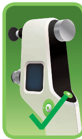
Tonometrenin doğru hizalanması ve yeşil prob taban ışığı göstergesi.
