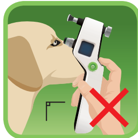
Tonometrenin yanlış hizalanması ve kırmızı prob taban ışığı göstergesi.
